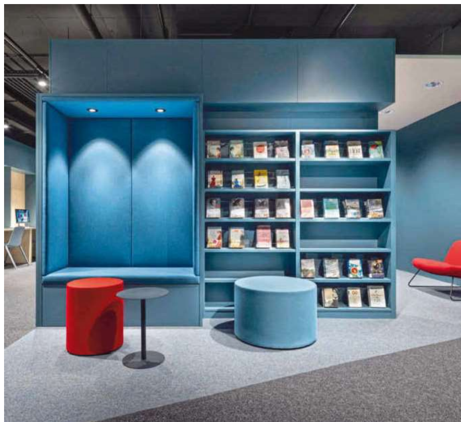
Akustisch wirksame Teppichfliesen sorgen für die nötige Ruhe.
